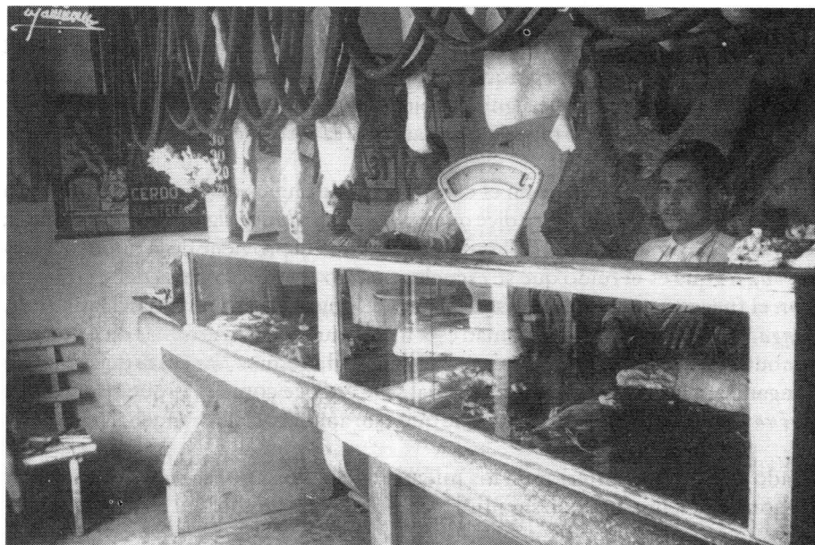
Nótese en la foto, una de las primeras básculas mecánicas que llegó a Morelia, marca: International Business Machines Corporation. 50 Broad S.T. New York city. Manufactured by Bayton Scale Company. Division Dayton, O. USA. Patented-oct/19/1915 aug/29/1916 Style No. MF 47 Capacity 5 kg. Dicha báscula sustituyó a la antigua balanza.
